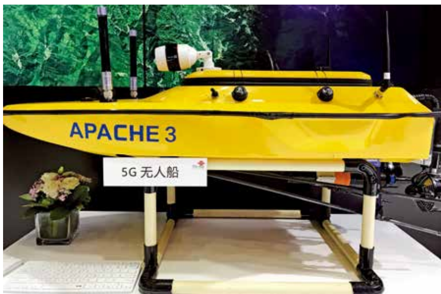
5月5日，福建福州，第二届数字中国建设成果展览会上展出的5G无人船，其搭载高清摄像头、水质采样及在线检测仪的设备，可以采集水域信息，自动绘制水质分布图、生成采样报告及检测报告。图/本刊记者 潘树琼 摄
