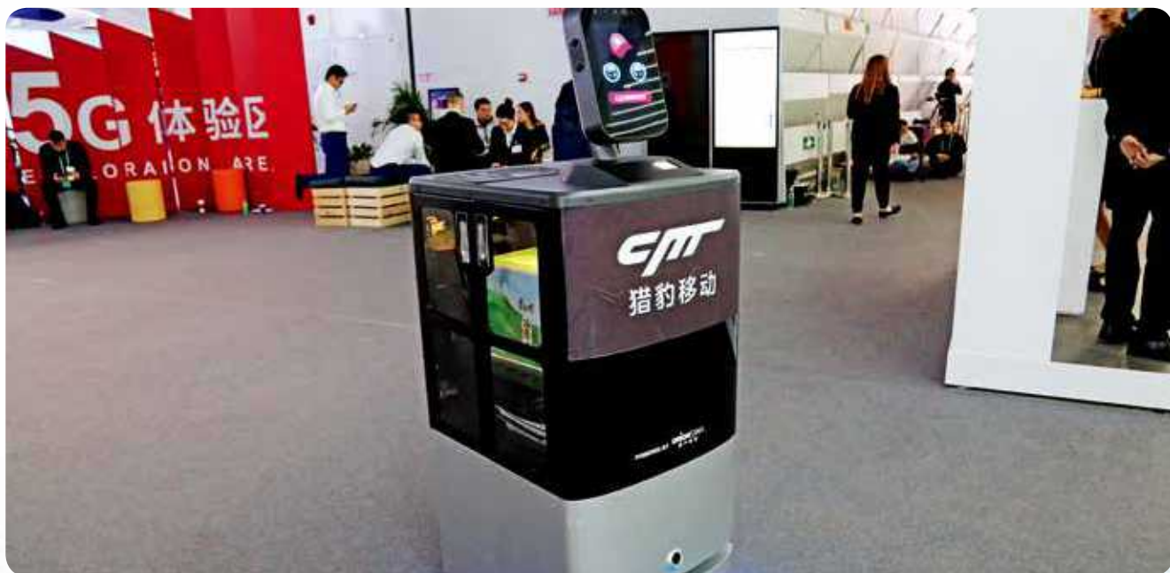
“豹小递”智能交互送货机器人正在工作，可实现自主路径规划、智能避障、语音控制、主动揽客、闲时自动充电等功能。
