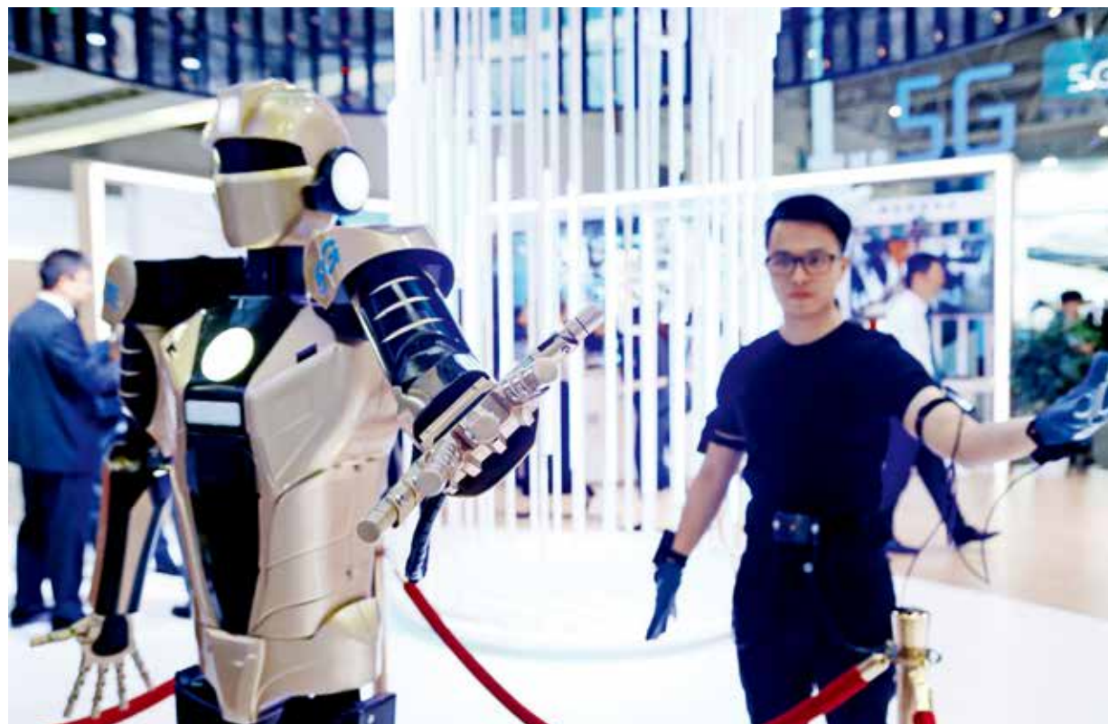
一位现场工作人员胳膊上戴着传感器，通过数据连接到机器人身上，机器人可以实时完全模仿工作人员的动作。据介绍，这项技术可以使机器人在危险工作中替代人类。
